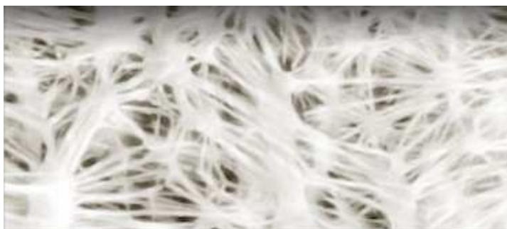
Figura 12: Imagem microscópica da membrana de teflon Gore-tex®. Fonte: www.gore-tex.com
