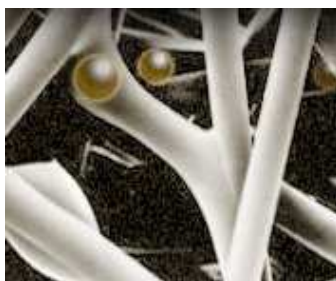
Figura 11: Comparação do tamanho das partículas de vapor em relação aos orifícios da membrana. Fonte: www.gore-tex.com
