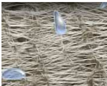
Figura 10: Comparação do tamanho das gotas de água com a abertura dos orifícios da membrana. Fonte: www.gore-tex.com
