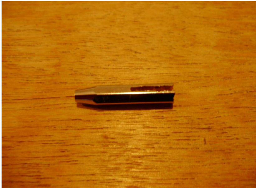
Cabo do espelho cortado em 2,5cm e depois cortado ao meio com serra de metal
