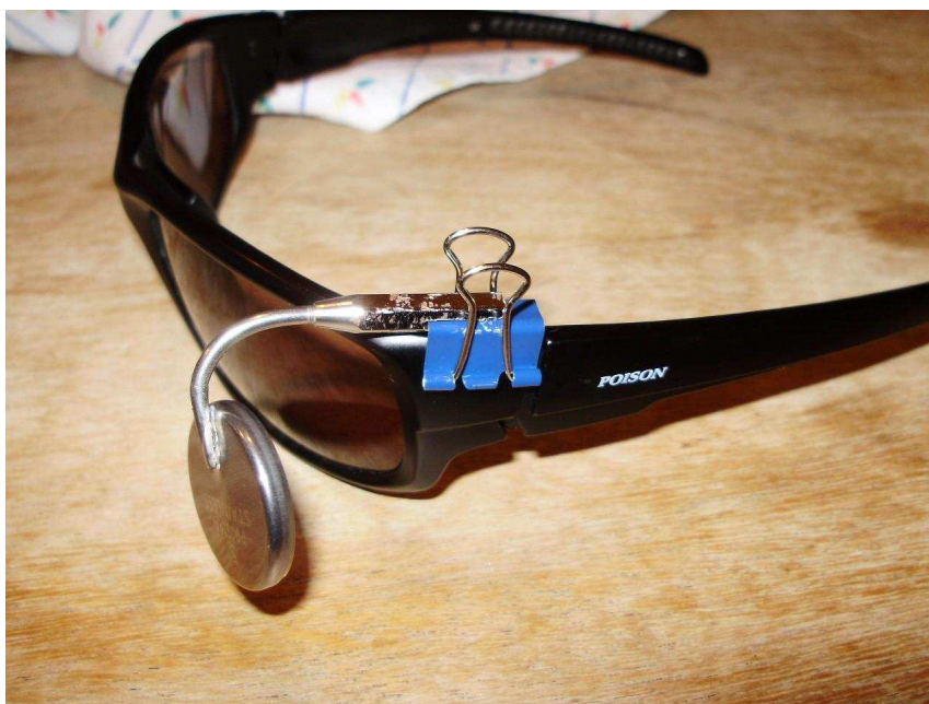
Espelho já montado no óculos Para ajustar, é necessário paciência e um alicate de bico para ir entortando até ficar no jeito
